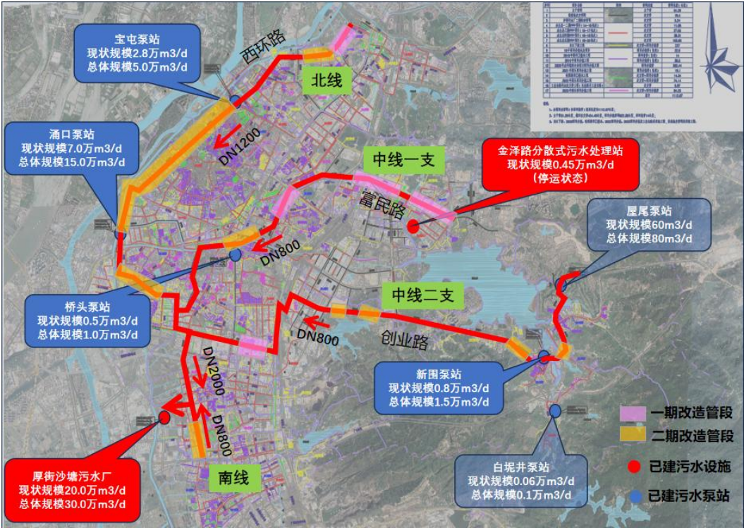
厚街镇主管问题整改管段总图
