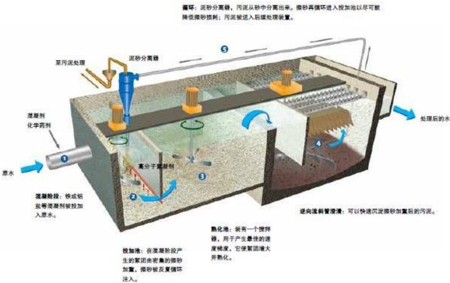
加砂沉淀池构造示意图
