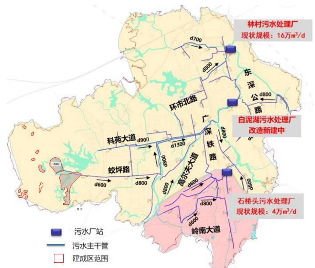
图 4.2-18 水库流域内居民区位置与污水干管的关系图
