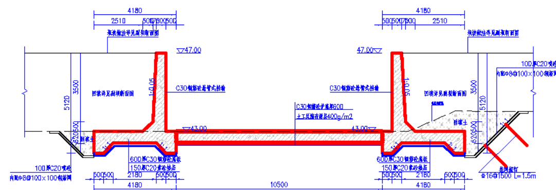
图 6.6-72 消力池段横断面图
