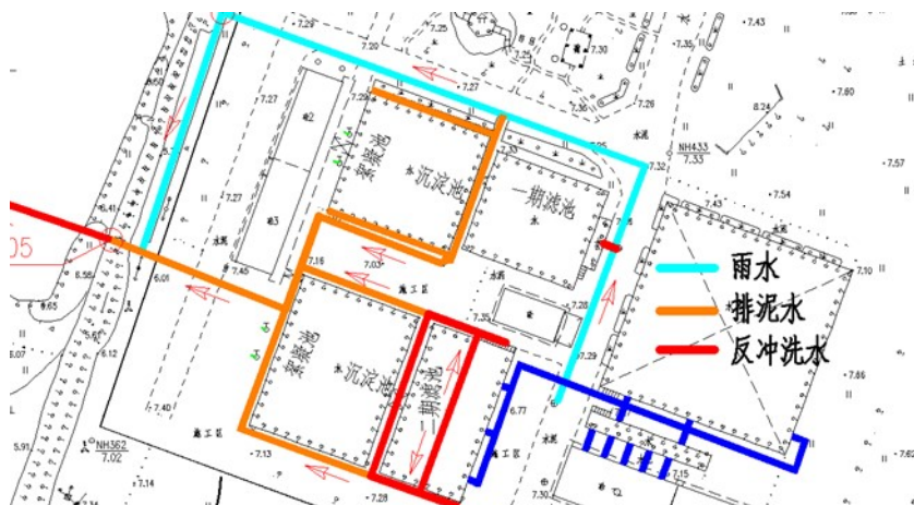
图 8-14 现状反冲洗水排放情况
